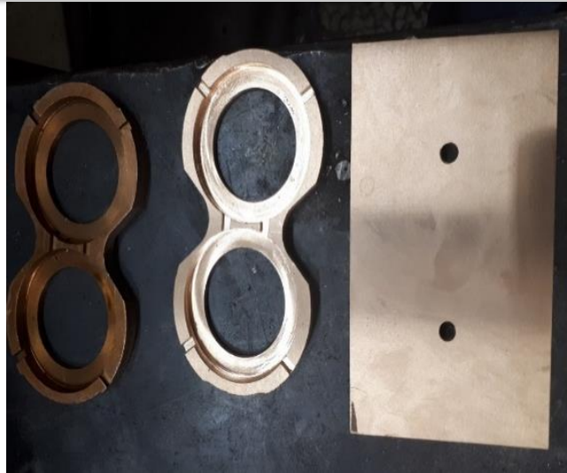
به ترتیب از راست: صفحه سنگ زده شده ، قطعه ساخته شده، قطعه فابریک
