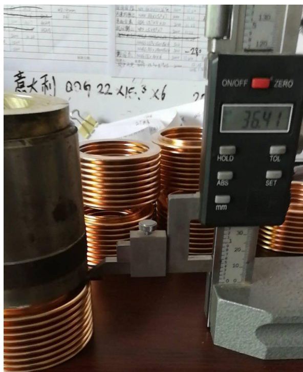
تست نیرو- جابجایی بر روی بیلوز
