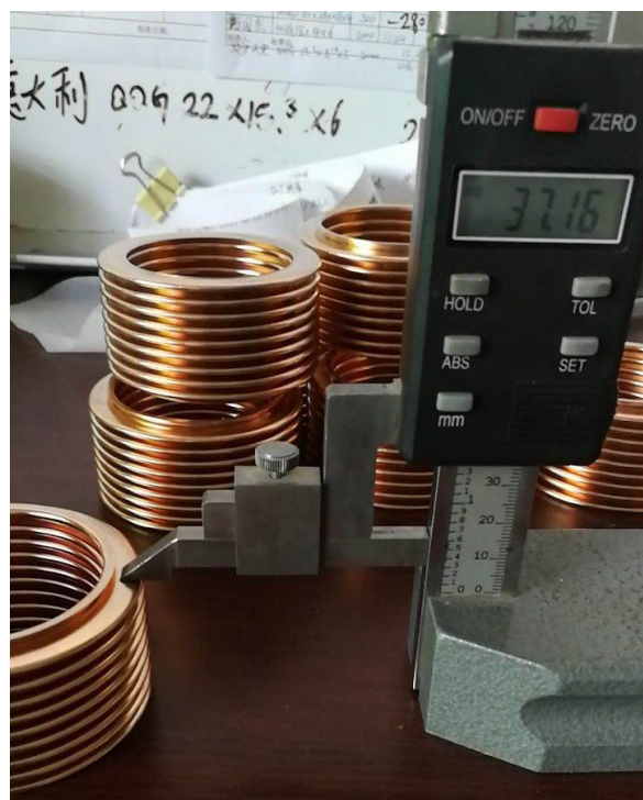
تست نیرو- جابجایی بر روی بیلوز
