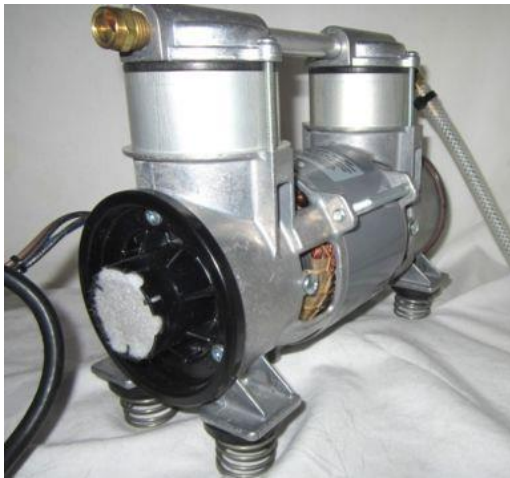
کمپرسور بدون روغن مورد استفاده در دستگاه اکسیژن ساز (Oil Free Compressor)
