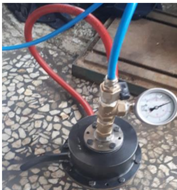
تست عملکرد نهایی درین ولو در خط توربین راستون
