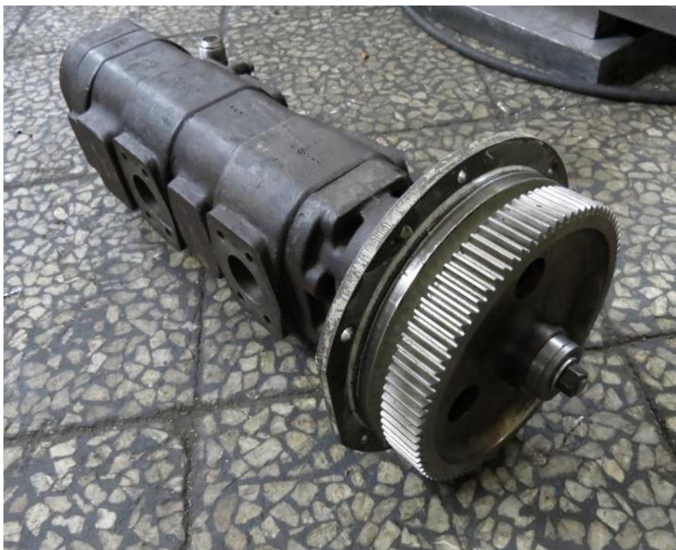
پمپ روغن تعمیر شده
